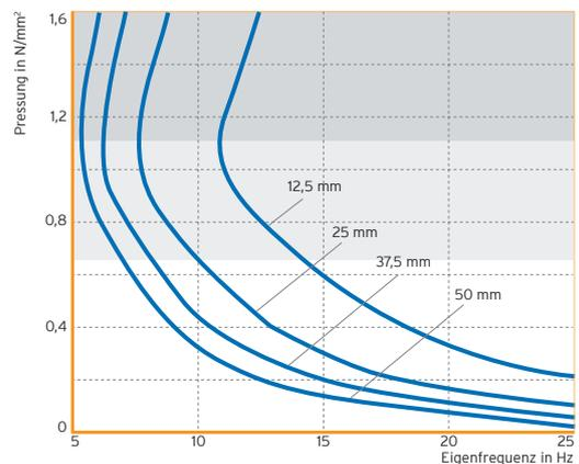
Eigenfrequenz eines Schwingensystems mit einem Freiheitsgrad, bestehend aus einer starren Masse und einer elastischen Lagerung aus Sylodyn® NE auf unachgiebigem Untergrund; Parameter: Dicke des Sylodynlagers
