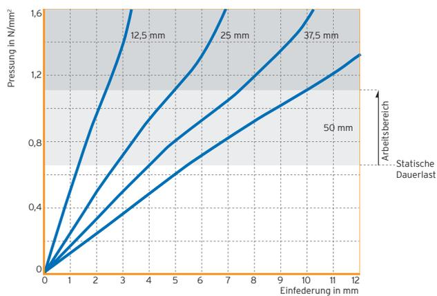
Quasistatische Federkennlinie mit einer Verformungsgeschwindigkeit von 1 % der Dicke pro s; Prüfung zwischen ebenen Stahlplatten; Aufzeichnung der 3. Belastung; Prüfung bei Raumtemperatur
