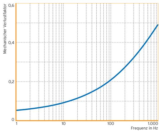
DMA-Untersuchungen; Masterkurve mit einer Referenztemperatur von  $21^{\circ}\text{C}$ ; Messungen im linearen Bereich der Federkennlinie, bei geringer Pressung
