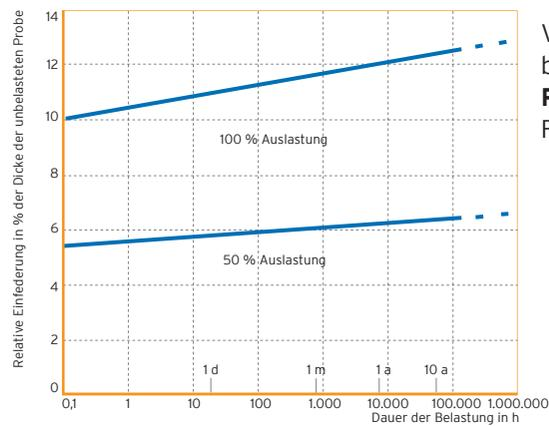
Verformungszunahme unter gleich bleibender Druckbelastung
