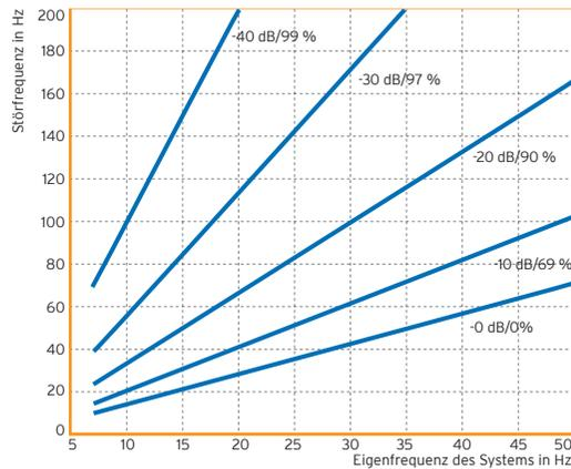
Verminderung der Übertragung mechanischer Schwingungen durch den Einbau einer elastischen Lagerung aus Sylodyn® NE
